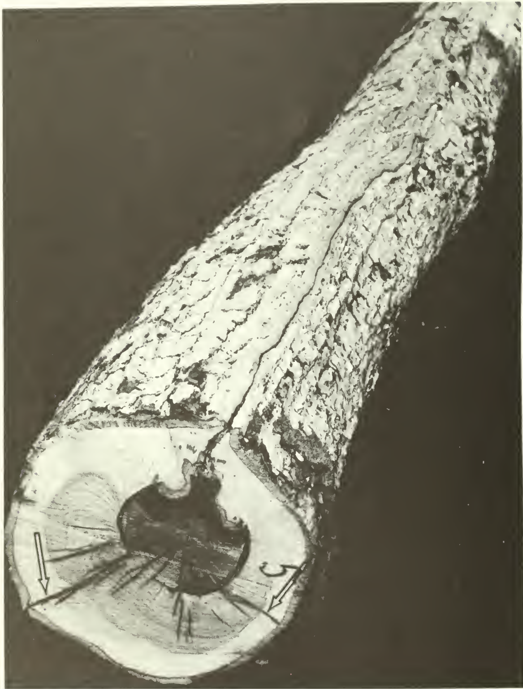
Abb. 9. — Auch das Bild dieser Weiß-Eiche zeigt die Verbindung einer vor längerer Zeit entstandenen Wunde mit der Ausbildung eines Radialrisses, der auf der Stammoberfläche als schmale, schwarze Linie erkennbar ist. Weitere kleinere Risse sind auf der gegenüberliegenden Seite der ehemaligen Wunde entstanden, von denen zwei die Rinde bereits erreicht haben (Pfeile). Beachte die zentral gelegene Fäule, die vom Baum erfolgreich kompartimentiert worden ist.
