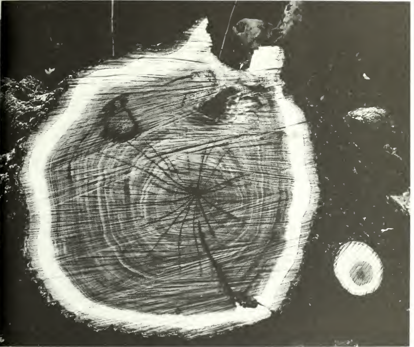
Abb. 18.— Wird der Sägeschnitt zu hoch oder zu tief ausgeführt, verfehlt man oft den eigentlichen Ursprungsort der Radialrisse. So scheinen die Sternrisse im vorliegenden Fall im Mark des Stammes entstanden zu sein (vergl. Abb. 19).
