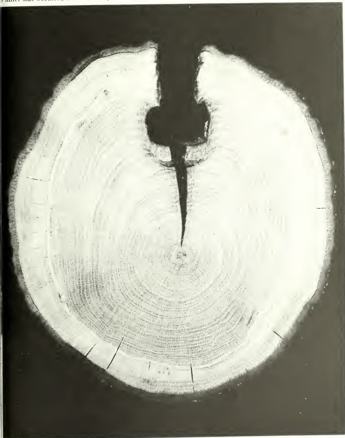
Abb. 20. — Radialrisse können ihren Ausgangspunkt auch von eingewachsenen Totästen aus nehmen. (Der Spalt auf der Innenseite des Astloches entstand nach der Trocknung der Baumscheibe.)
